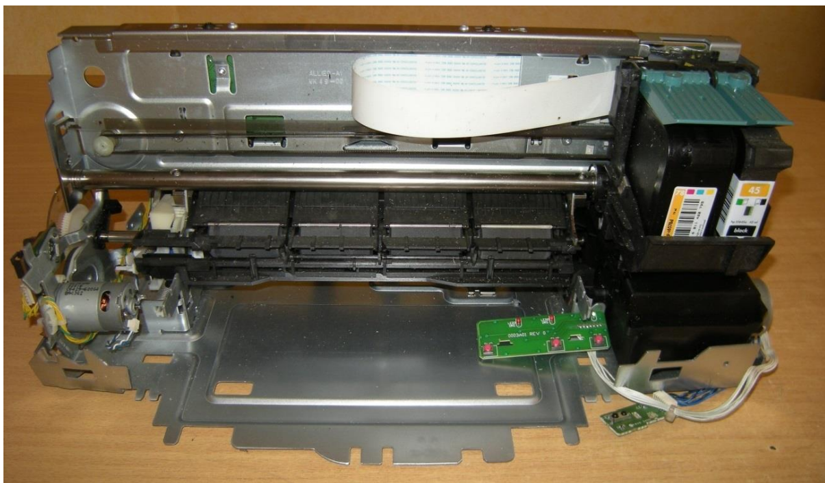
Obrázek 56: Rám tiskárny zepředu po odstranění plastových krytů
