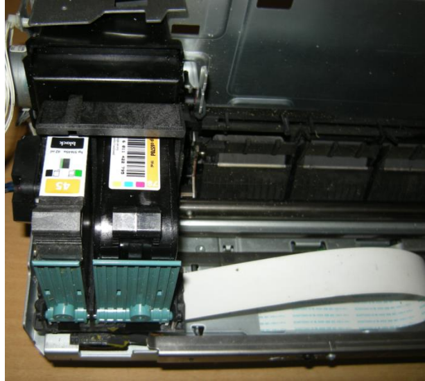
Obrázek 59: Tiskové patrony na lineárních pojezdech tiskárny.
