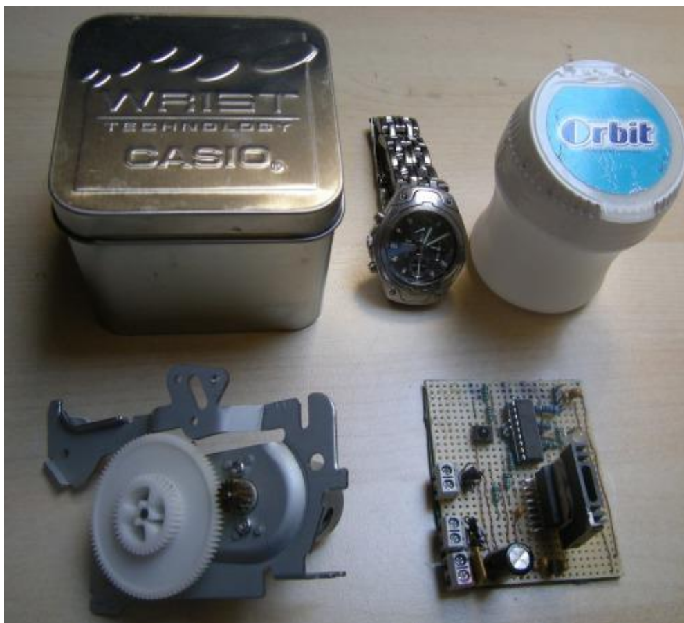
Obrázek 28: Hlavní díly ke stavbě Watch Winder Orbit Peppermint
